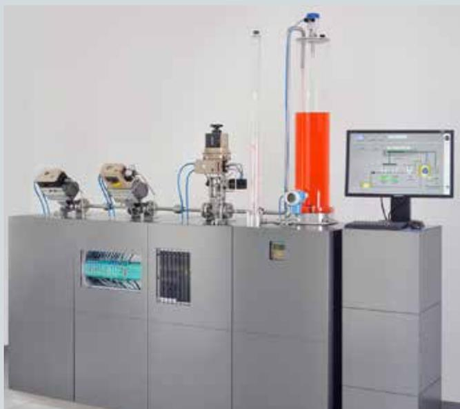
Abbildung 1: Demonstrationsmodell eines gesamten sicherheitsgerichteten Systems bei SAMSON
