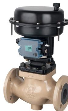
**Bild 2:** Antrieb Typ 3372 · Antriebsfläche 350 cm<sup>2</sup> · mit direkt angebautem Stellungsregler Typ 3725
