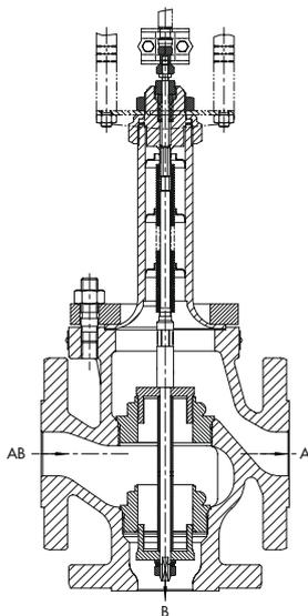
**Bild 5:** Dreiwegeventil für Wärmeträgeröl Typ 3535 Kegelanordnung für Verteilbetrieb
