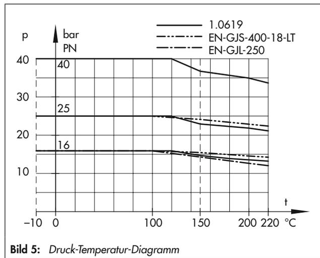
Bild 5: Druck-Temperatur-Diagramm
