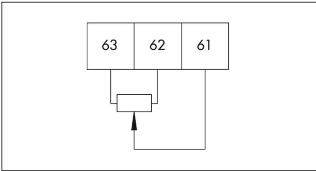
**Bild 6:** Elektrischer Anschluss · Widerstandsfernegeber
