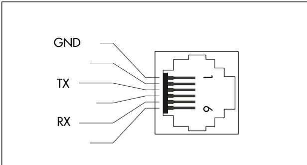
**Bild 7:** Belegung der RJ-12-Buchse
