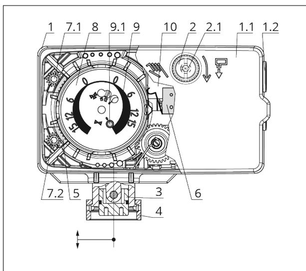
**Bild 2:** Aufbau Typ 5827 (kraftschlüssiger Anbau)
