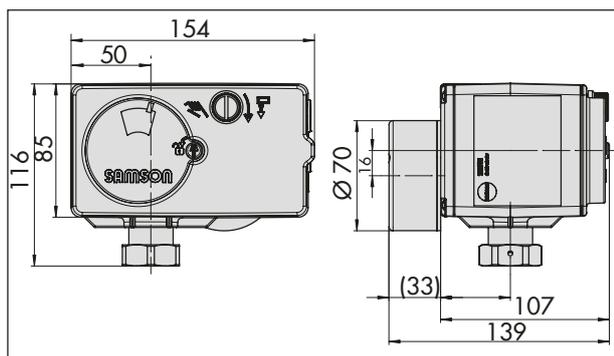
**Bild 10:** Maße in mm · Schnellläufer mit kraftschlüssigem Anbau
