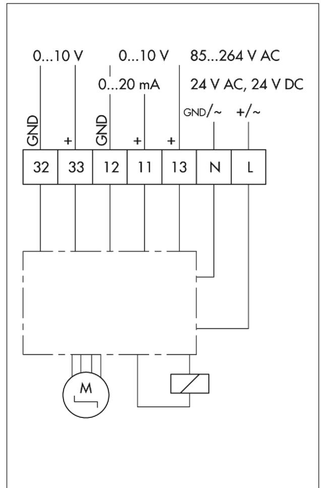
**Bild 4:** Elektrischer Anschluss · Stellungsregler
