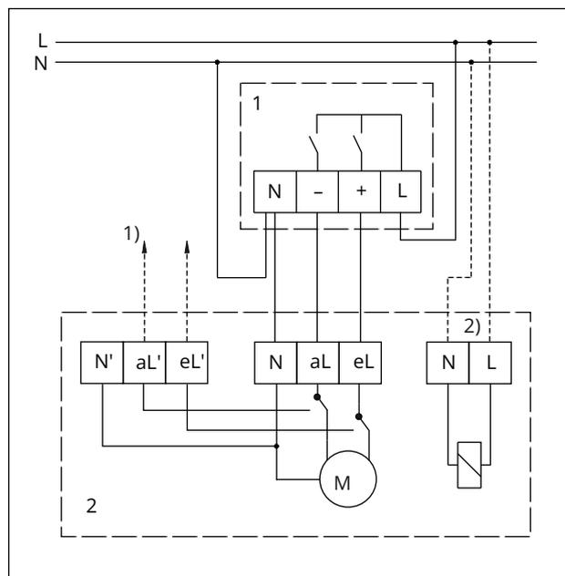
**Bild 3:** Elektrischer Anschluss · Dreipunkt-Ausführung
