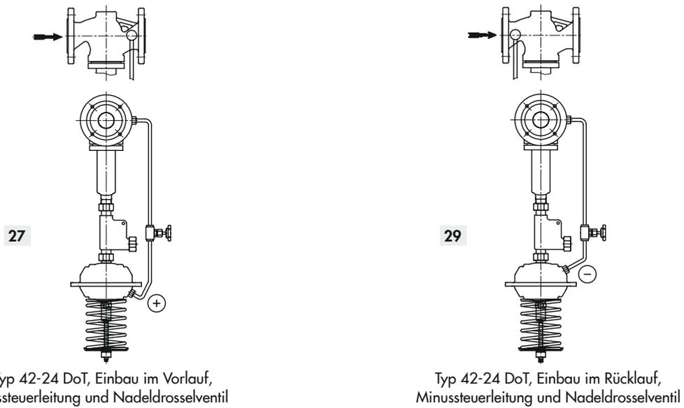
Bild 8.10: Vormontierte Steuerleitungen für Typ 42-24 DoT
