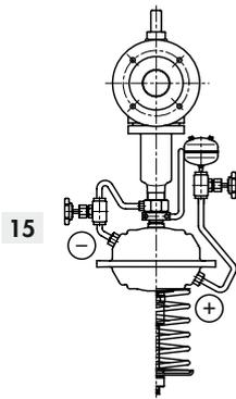
15 Anschlussstück mit externem Steuerleitungsanschluss, Minussteuerleitung und untere Plussteuerleitung, zwei Nadeldrosselventile, Auskühlgefäß mit Befestigungsbügel
