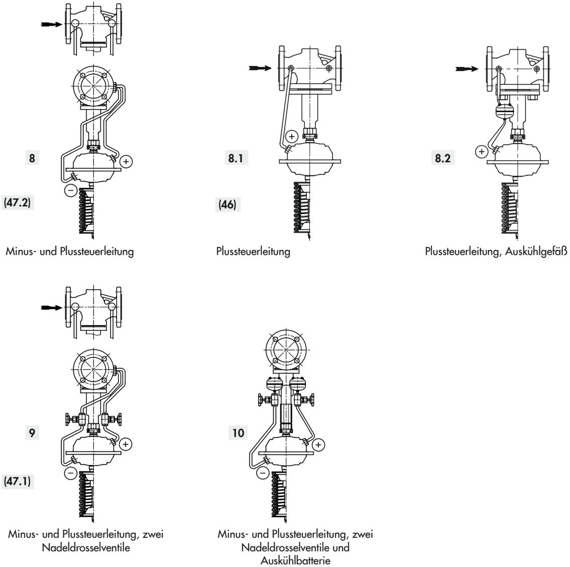
Bild 8.3: Vormontierte Steuerleitungen für Typ 42-20, Typ 42-25
