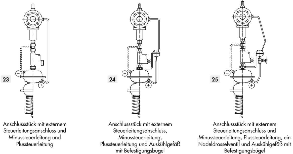
Bild 8.8: Vormontierte Steuerleitungen für Typ 42-36 DoT und Typ 42-37 DoT
