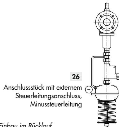
Bild 8.9: Vormontierte Steuerleitungen für Typ 42-34 DoT und Typ 42-38 DoT bei Einbau im Rücklauf
