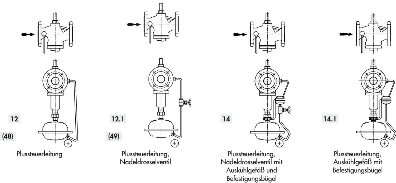
Bild 8.4: Vormontierte Steuerleitungen für Typ 42-36
