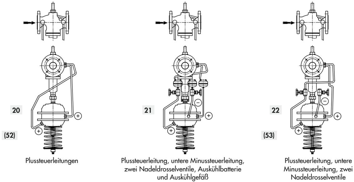
Bild 8.7: Vormontierte Steuerleitungen für Typ 42-39 bei Einbau im Vorlauf
