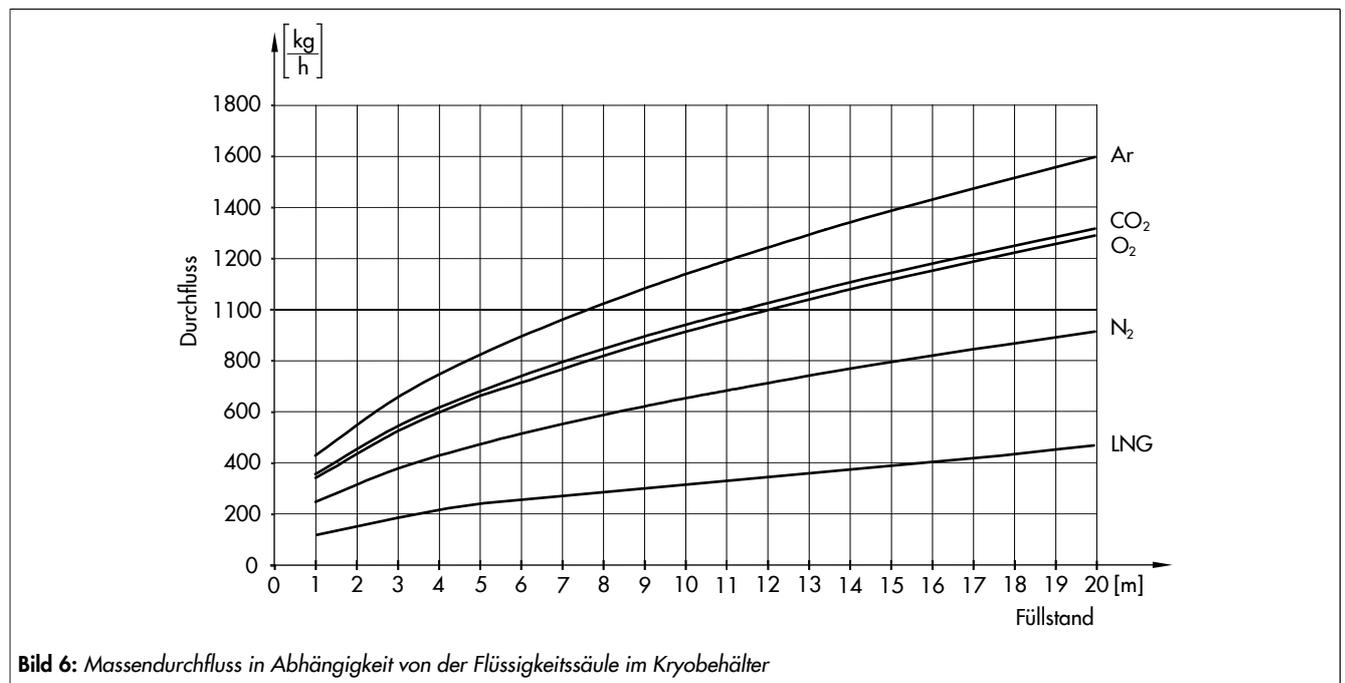
**Bild 6: Massendurchfluss in Abhängigkeit von der Flüssigkeitssäule im Kryobehälter**
