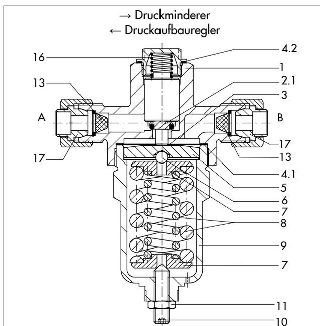
Bild 3: Druckaufbauregler oder Druckminderer Typ 2357-1 (PN 50)
