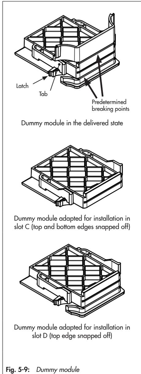
Fig. 5-9: Dummy module
