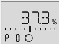
Nach erfolgreicher Initialisierung wechselt die Anzeige zum Code **PO** und der Stellungsregler geht in den Regelbetrieb, erkennbar am Regelsymbol .
