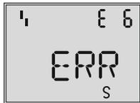
Zur Abhilfe muss der Nennbereich (Code **P4**) geändert und die Initialisierung neu gestartet werden.
