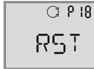
\* 6 s lang halten (Anzeige **6-5-4-3-2-1-**), **RST** blinkt, solange die Sterntaste \* gehalten wird. Sobald die Taste losgelassen wird, ist der Resetvorgang abgeschlossen und der Stellungsregler wechselt zur Betriebsanzeige **P0**.
