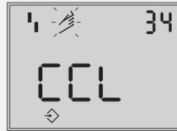
关闭方向 (使阀门移动到 CLOSED 位置的旋转方向) (在定位器显示器上查看)
