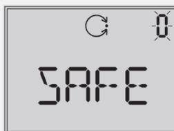
阀门移动到故障-安全位置。如果定位器已初始化，则当前阀门位置以%显示。
