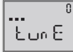
交替读数显示：正在进行初始化
