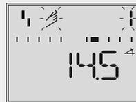
Handsollwert (angezeigt wird der aktuelle Drehwinkel)
