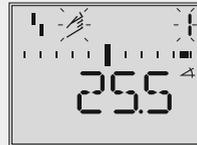
Handsollwert  $w$  (angezeigt wird der aktuelle Drehwinkel)
