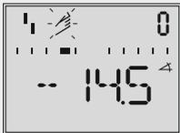
Ein nicht initialisierter Stellungsregler zeigt nach der Laufschrift **iESinG** blinkend das -Ausfallsymbol und das -Handsymbol an. Der Zahlenwert gibt die Hebellage in Winkelgrad relativ zur Mittelachse wieder.
