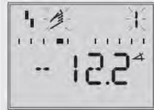
*tEStinG* 在显示器上运行后，当定位器未初始化时，错误报警图标出现，显示器上的手形图标闪烁。该读数以度为单位表示反馈杆相对于中轴线的位置。
