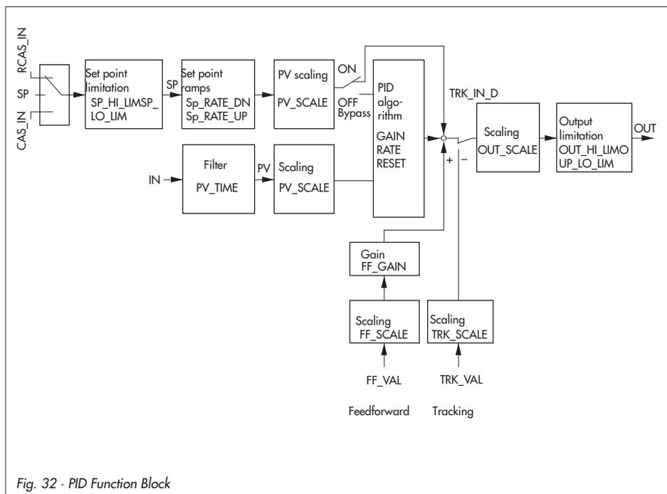
Fig. 32 · PID Function Block
