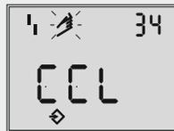
Schließrichtung (Drehrichtung, durch die die ZU-Stellung des Stellventils erreicht wird; Blickrichtung auf Display des Stellungsreglers)
