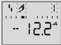
Ein **nicht initialisierter Stellungsregler** zeigt nach der Laufschrift *testinG* das -Störmeldesymbol und blinkend das -Handsymbol an. Der Zahlenwert gibt die Hebellage in Winkelgrad relativ zur Mittelachse wieder.
