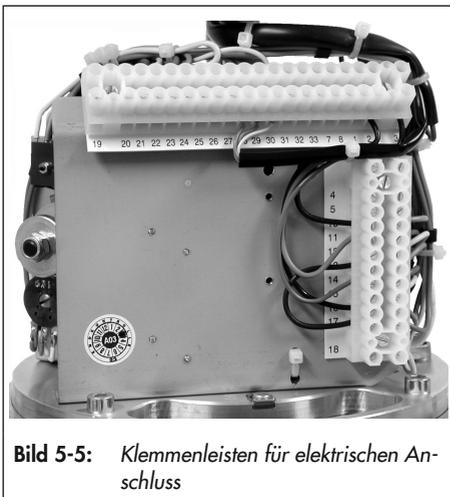
**Bild 5-5:** Klemmenleisten für elektrischen Anschluss
