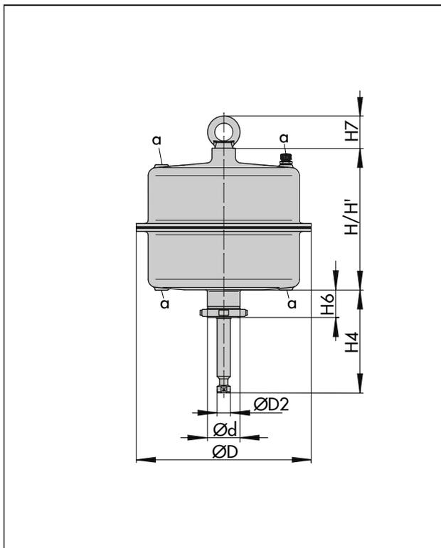
Bild 4: Typ 3271 mit 1400-120 cm<sup>2</sup> Antriebsfläche
