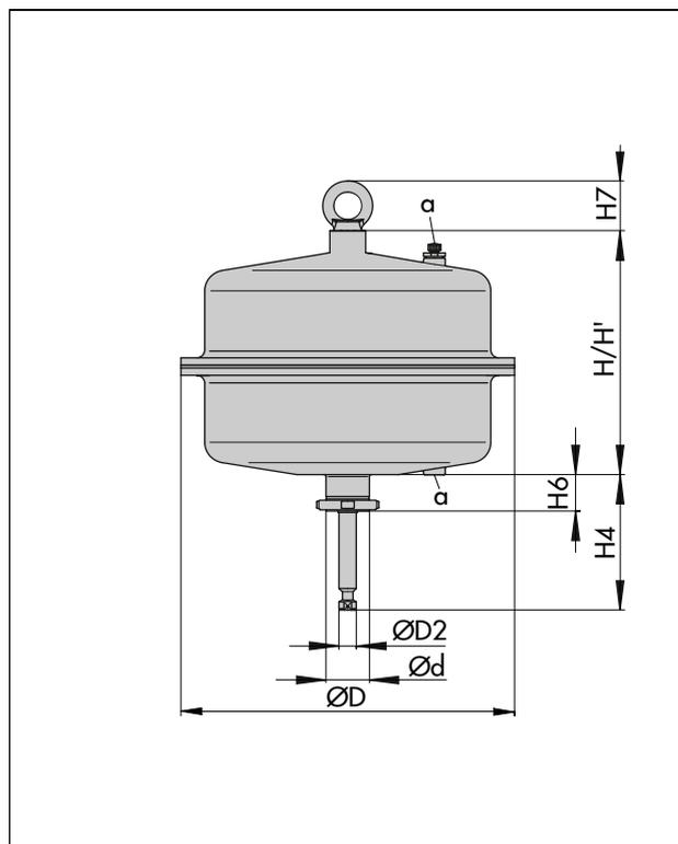
Bild 5: Typ 3271 mit 2800 cm<sup>2</sup> Antriebsfläche
