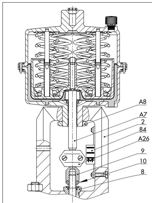
**Bild 10:** Pneumatischer Antrieb Typ 3271 an Hubventil angebaut
