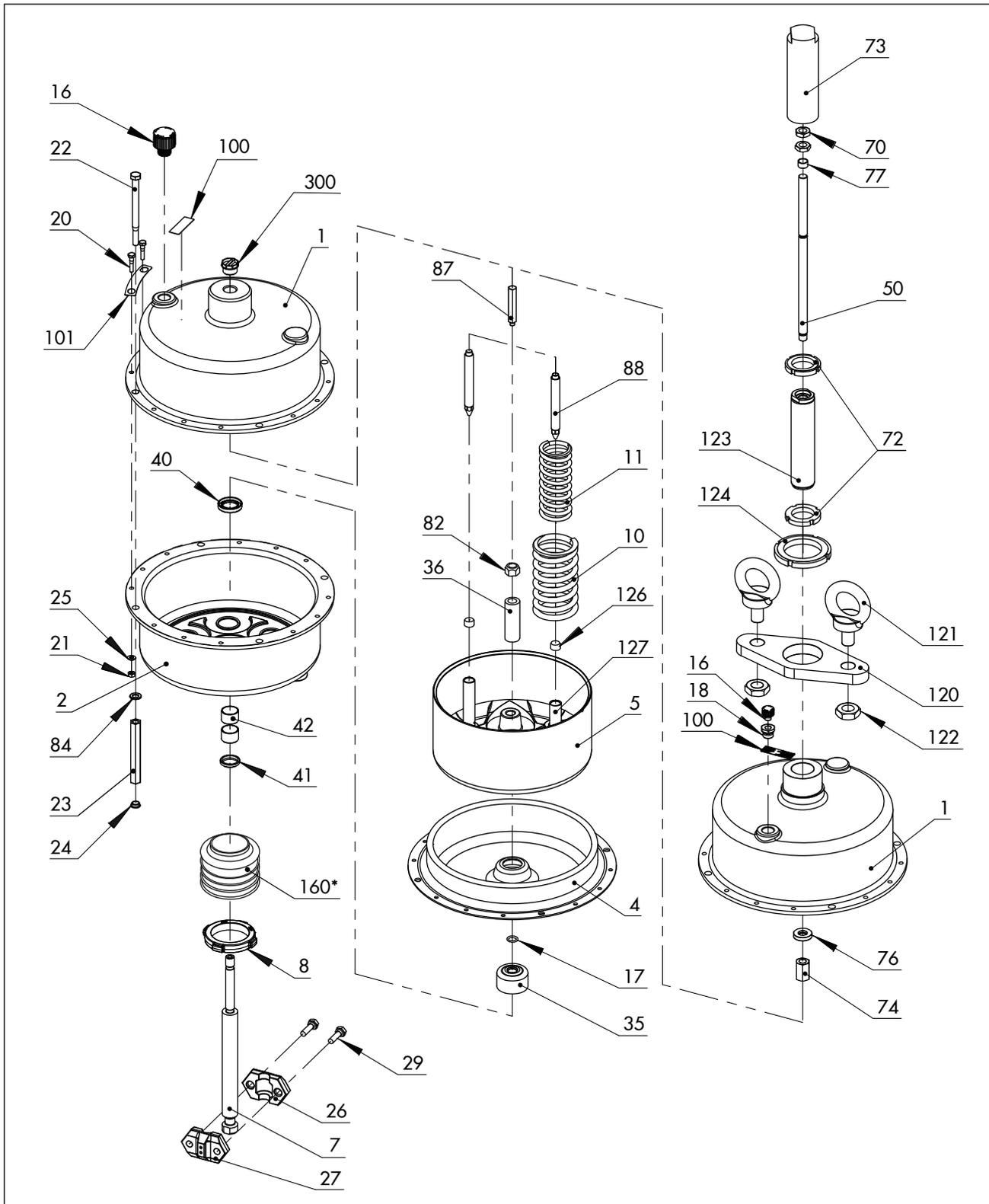
Bild 17: Antrieb Typ 3271, 1400-120 cm<sup>2</sup>
