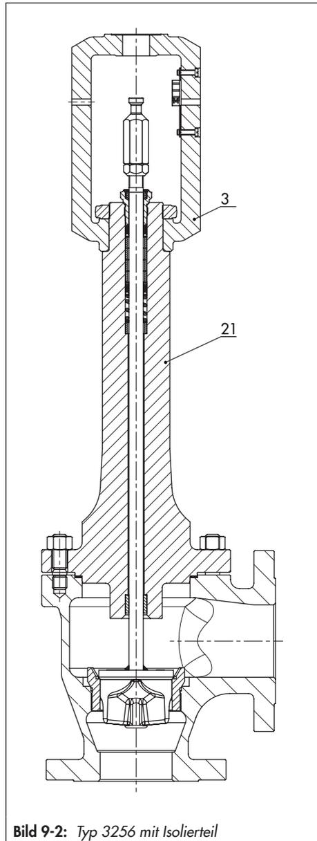
**Bild 9-2:** Typ 3256 mit Isolierteil
