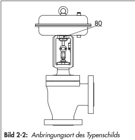
**Bild 2-2:** Anbringungsort des Typenschilds
