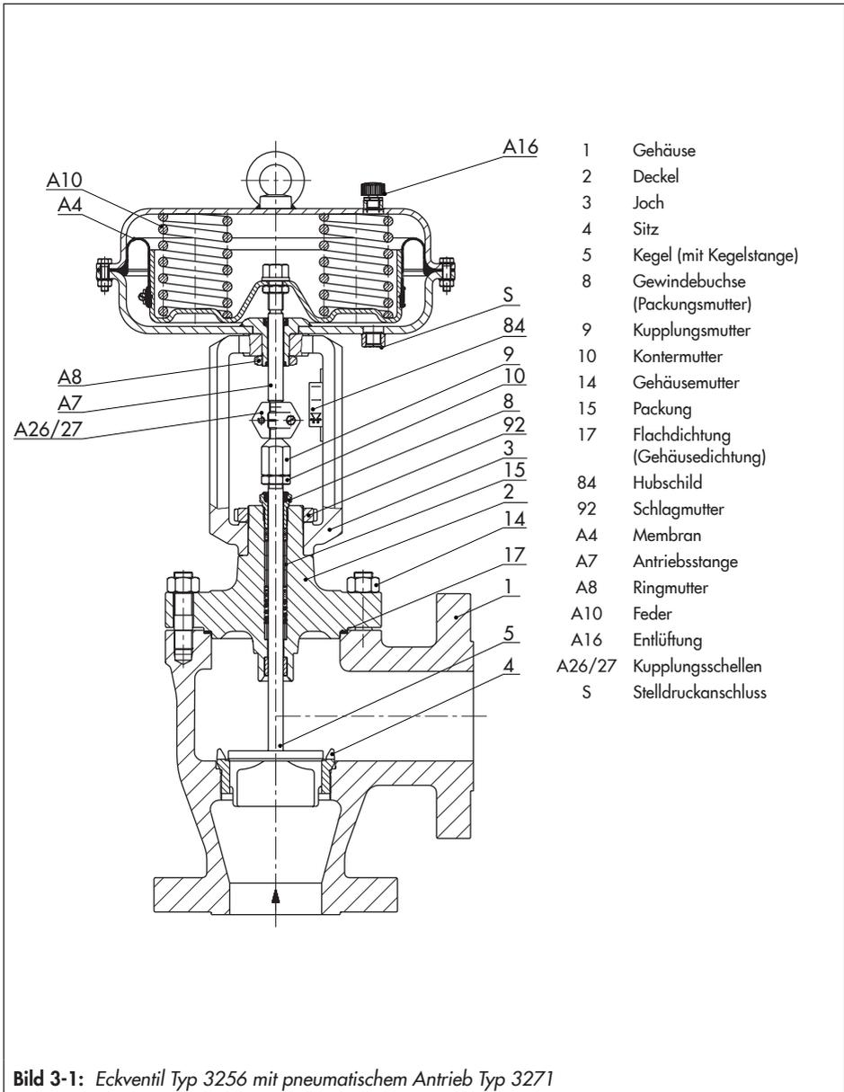
**Bild 3-1:** Eckventil Typ 3256 mit pneumatischem Antrieb Typ 3271
