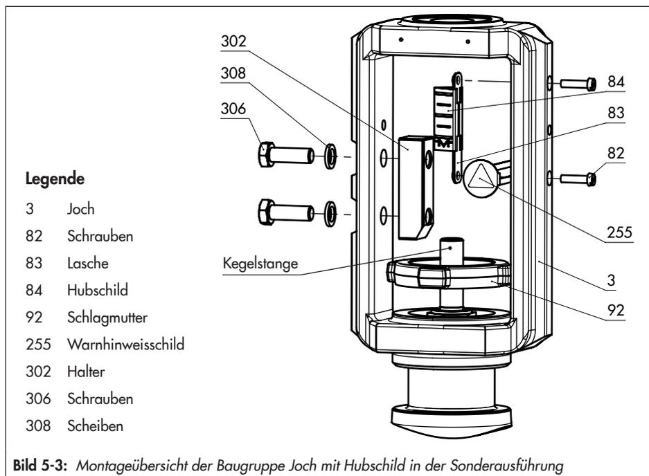
**Bild 5-3:** Montageübersicht der Baugruppe Joch mit Hubschild in der Sonderausführung
