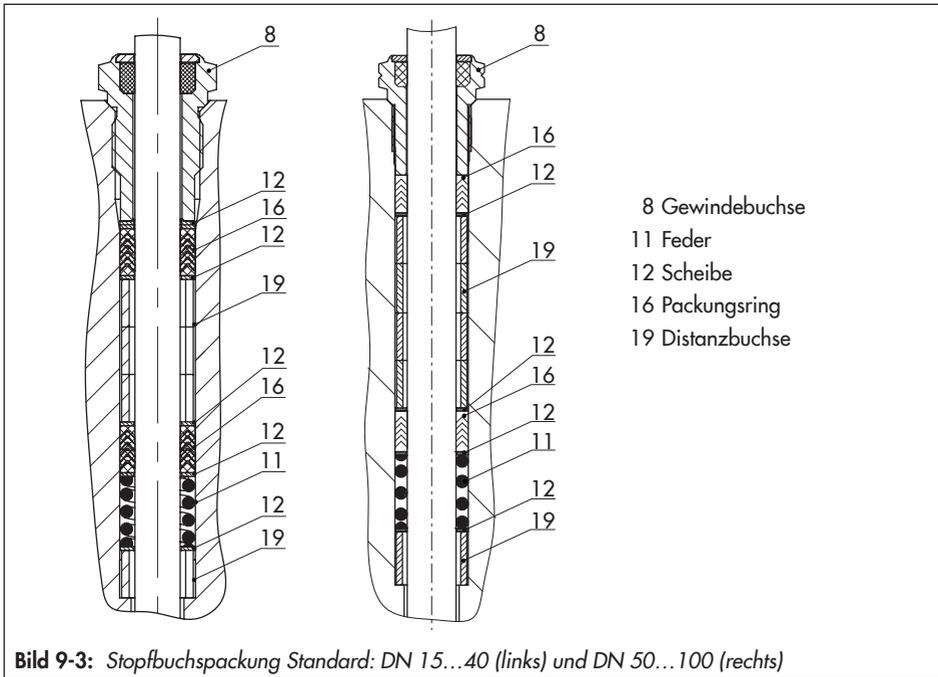
3. Dichtringe (15.2) über die Kegelstange schieben.
