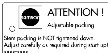
Fig. 2: Etikett när en justerbar packning har installerats
