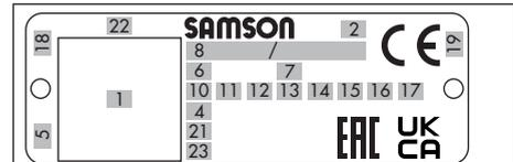
Fig. 2-2: Posiciones en la placa de características de la válvula Tipo 3251
