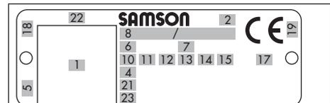
Fig. 2-3: Posiciones en la placa de características de la válvula Tipo 3251-AM
