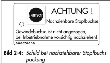
**Bild 2-4:** Schild bei nachziehbarer Stopfbuchspackung
