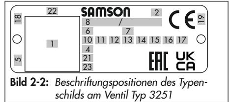
Bild 2-2: Beschriftungspositionen des Typenschildes am Ventil Typ 3251
