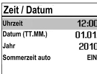
Drehschalter auf die Schalterstellung ☉ „Zeit/Datum“ stellen. Die aktuelle Uhrzeit ist ausgewählt (grauer Hintergrund).
