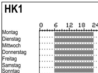
Drehschalter auf die Schalterstellung
