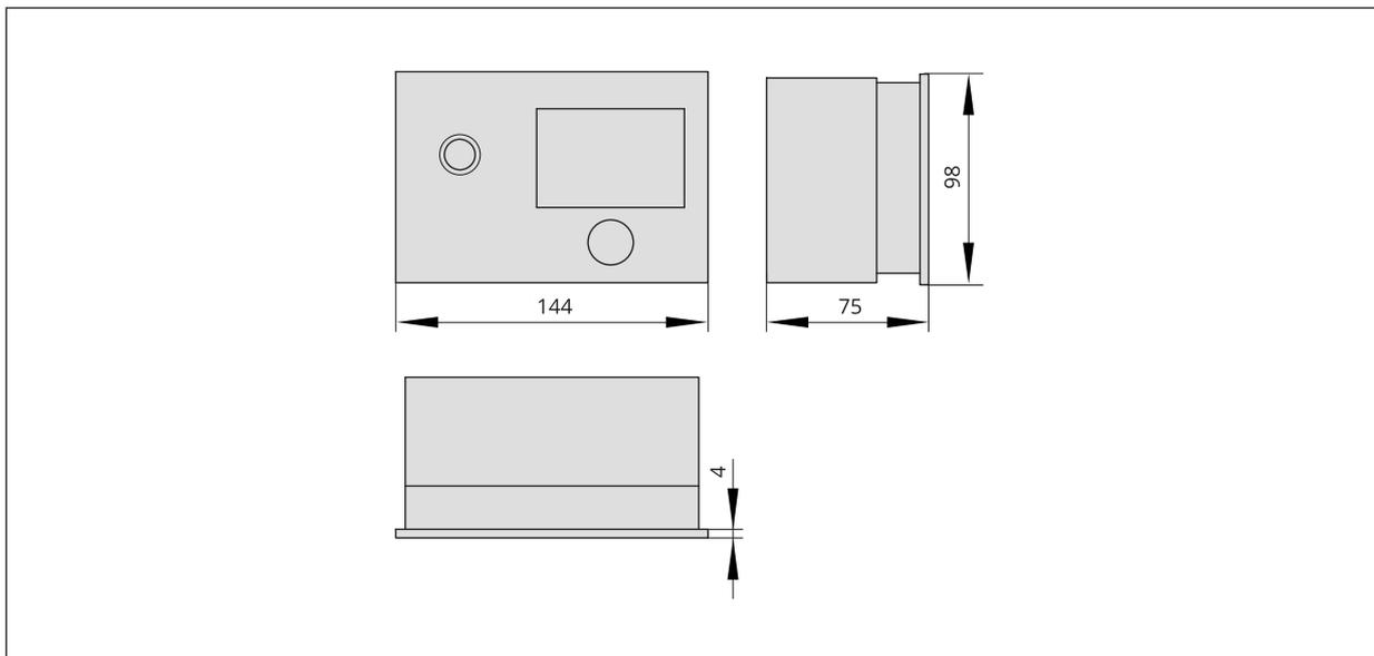
**Bild 1:** Maße in mm · Heizungs- und Fernheizungsregler
