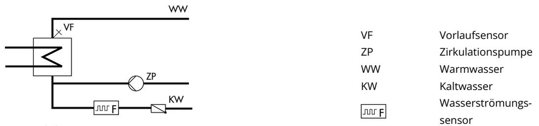
**Bild 20:** Aufbau eines Durchflusssystems
