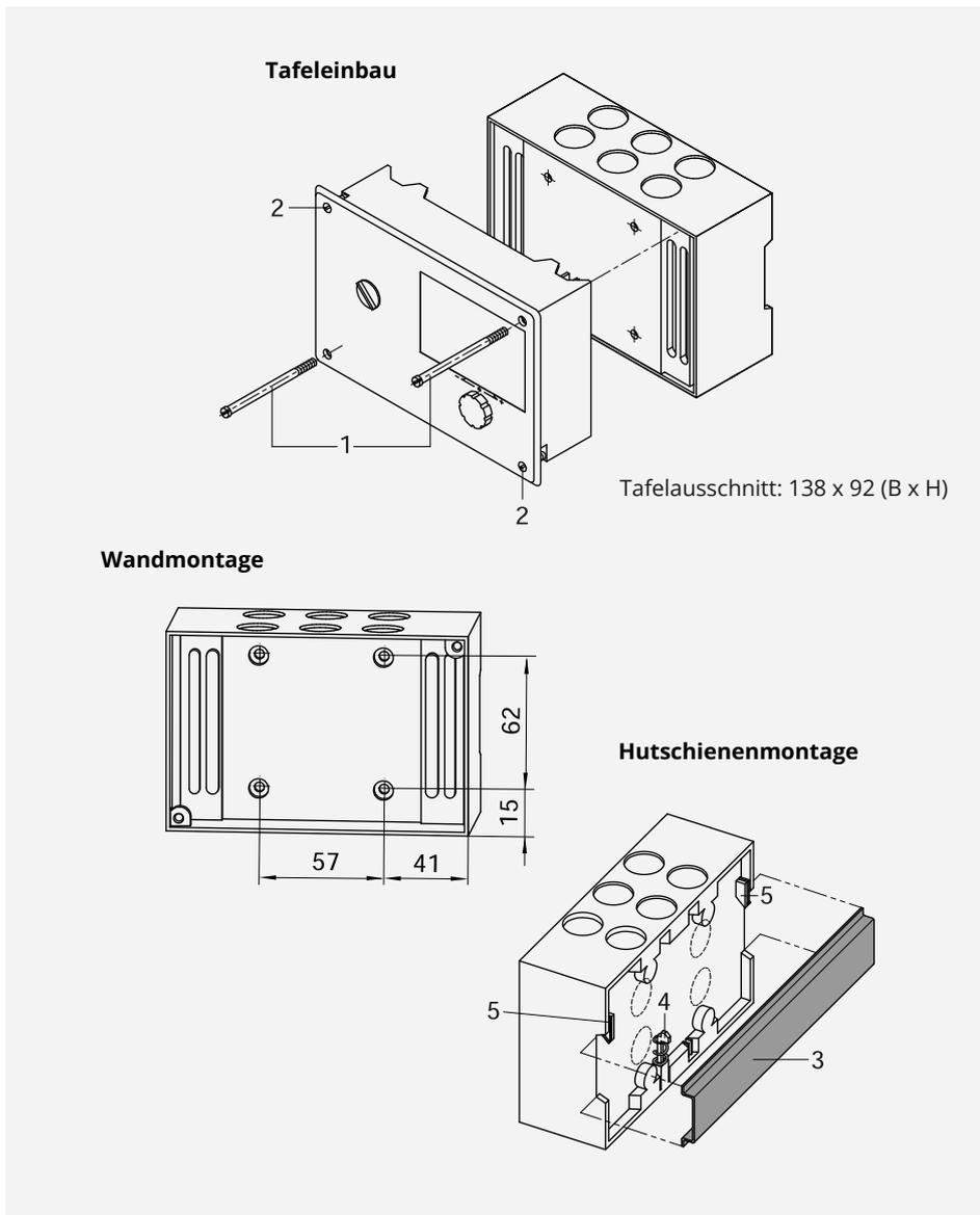
**Bild 2:** Montage · Maße in mm
