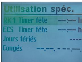
Tourner le sélecteur en position
