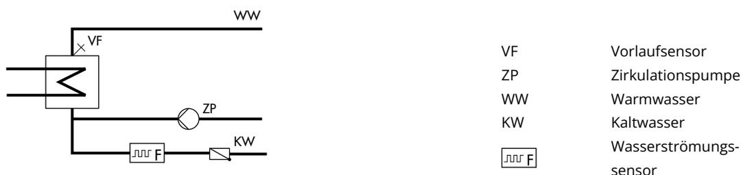
**Bild 17:** Aufbau eines Durchflusssystems
