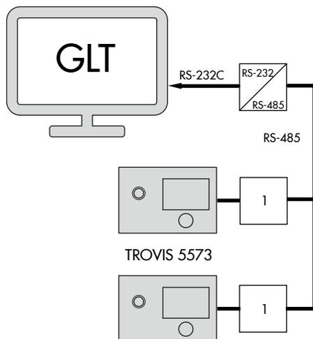
**Bild 18:** Netzaufbau
