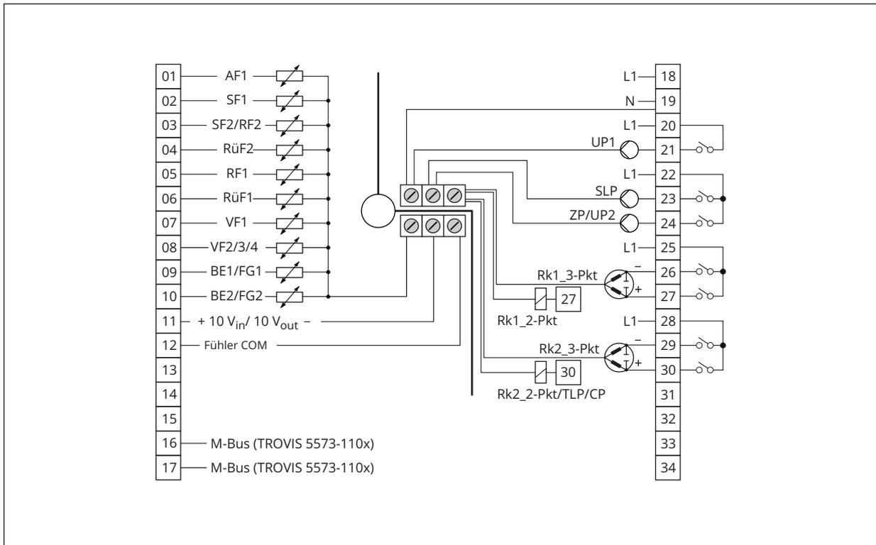
**Bild 4:** Elektrischer Anschluss des Reglers TROVIS 5573 mit Standard-Gehäuserückteil
