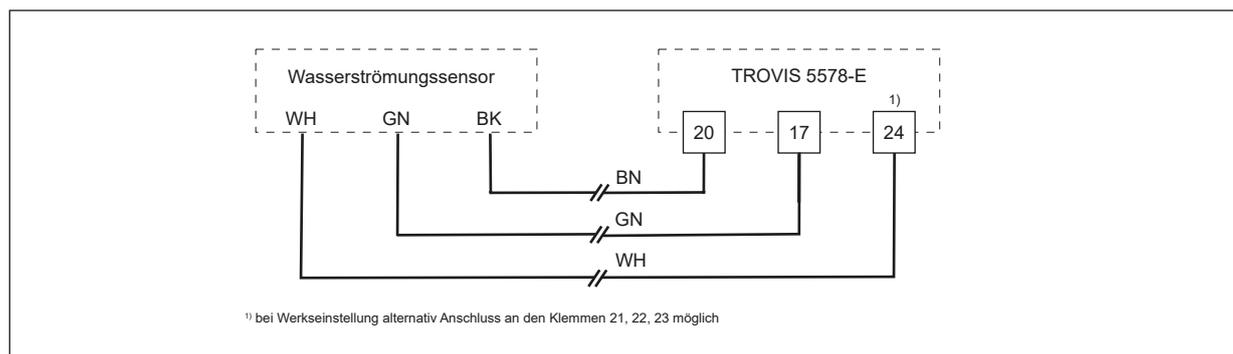
**Bild 8:** Wasserströmungssensor
