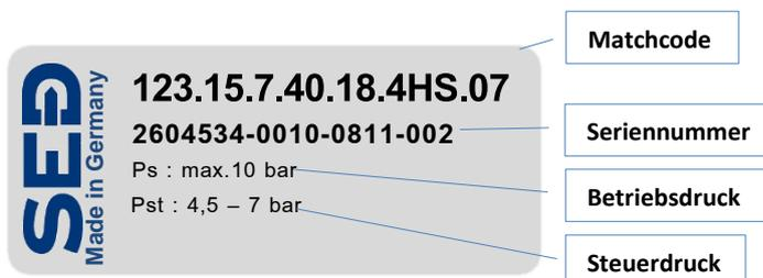
Das Typenschild wird in Form eines Klebeschildes auf dem Gerät angebracht und enthält wichtige Informationen zum Betrieb.
