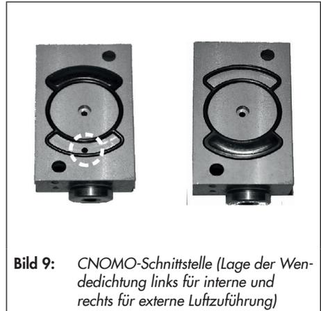
**Bild 9:** CNOMO-Schnittstelle (Lage der Wendedichtung links für interne und rechts für externe Luftzuführung)
