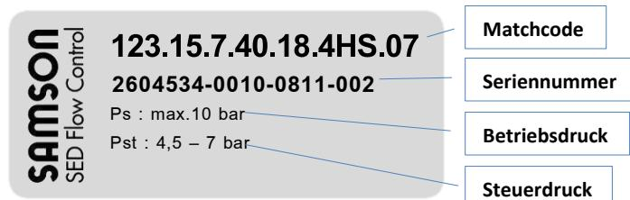
Das Typenschild wird in Form eines Klebeschilds auf dem Gerät angebracht und enthält wichtige Informationen zum Betrieb.
