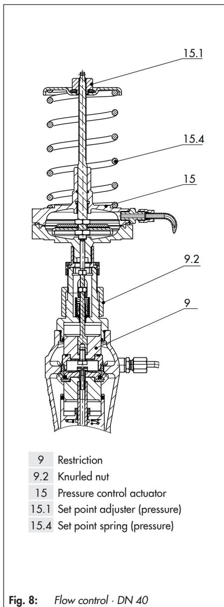
**Fig. 8:** Flow control · DN 40
