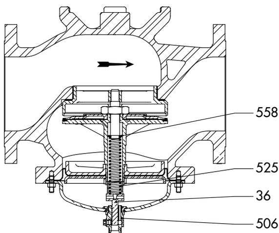
Bild 15-1: Ventil Typ 2422 für DN 65 bis 250 · membranentlastet
