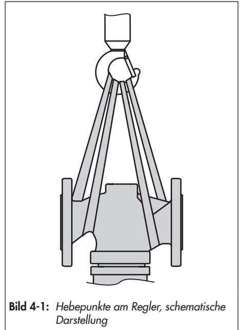
**Bild 4-1:** Hebepunkte am Regler, schematische Darstellung
