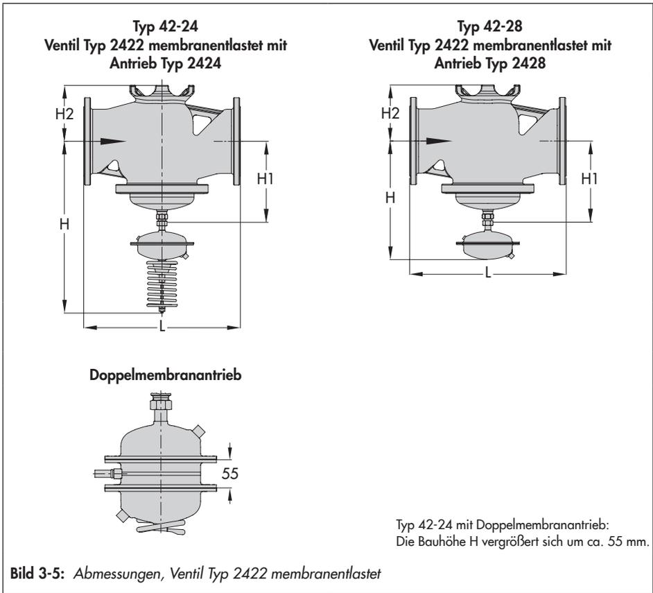
**Bild 3-5:** Abmessungen, Ventil Typ 2422 membranentlastet
