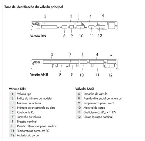
Fig. 4: Placa de identificação da válvula redutora de pressão Tipo 2333
