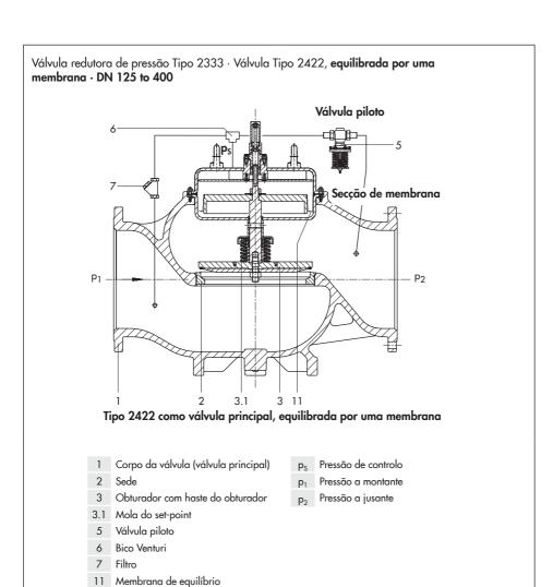
Fig. 2: Membrana funcional da válvula equilibrada por uma membrana
