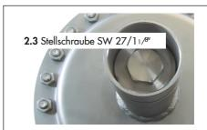
**Bild 2:** Hilfssteuerventil, Ansicht von oben auf die Stellschraube zur Sollwerteinstellung
