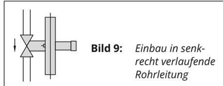
**Bild 9:** Einbau in senkrecht verlaufende Rohrleitung
