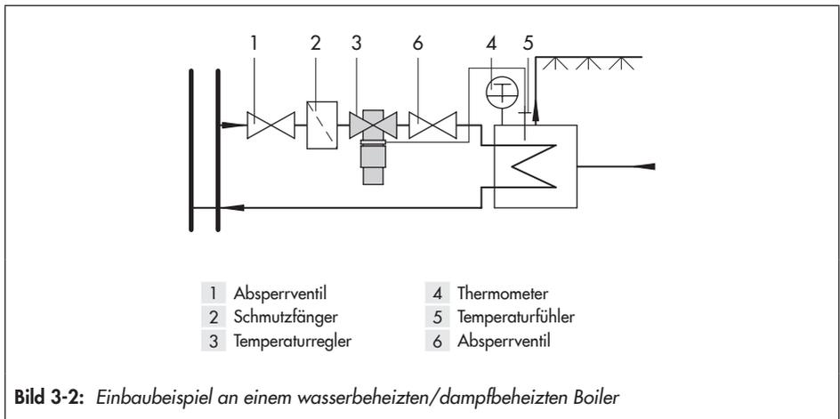
**Bild 3-2:** Einbaubeispiel an einem wasserbeheizten/dampfbeheizten Boiler
