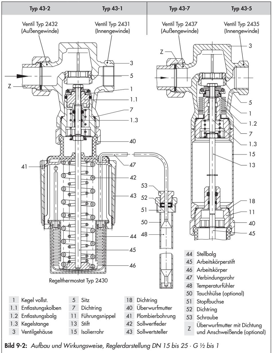
**Bild 9-2:** Aufbau und Wirkungsweise, Reglerdarstellung DN 15 bis 25 · G ½ bis 1
