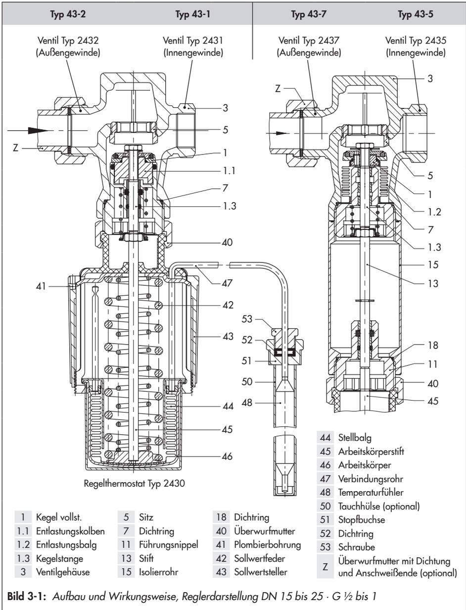
**Bild 3-1:** Aufbau und Wirkungsweise, Reglerdarstellung DN 15 bis 25 · G ½ bis 1
