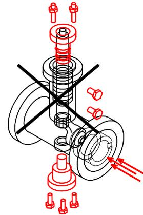
**⚠** Die seitliche Schraube ist kein Schnüffelanschluss. Sie dient als Ausblassicherung für die Welle und darf deshalb nicht während des Betriebes in der Rohrleitung bzw. in der Anlage demontiert werden.
