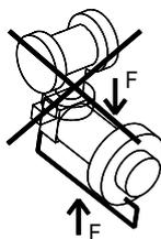
Sämtliche unsachgemäße Kräfteinwirkungen auf die Steuerleitung und Anbauteile
