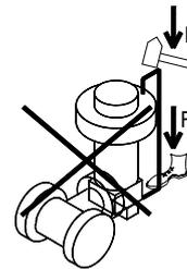
Das treten auf die Steuerleitung und die Anbauteile sowie die Beschädigung durch Werkzeuge ist ebenfalls nicht zulässig!
