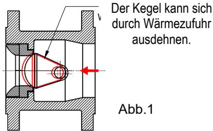
In der Aufheizungsphase ist die Armatur sehr unterschiedlichen Wärmeverteilungen ausgesetzt. Es kommt zu unterschieden Ausdehnungen der Bauteile. Dadurch kann sich der Kegel im Sitzring verklemmen (siehe Abb.1).
