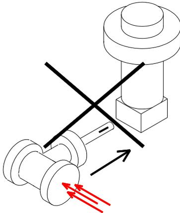
**⚠ ACHTUNG!** Während des Betriebes in der Rohrleitung bzw. in der Anlage dürfen nach außen Drucktragende Bauteile nicht gelöst bzw. demontiert werden!
