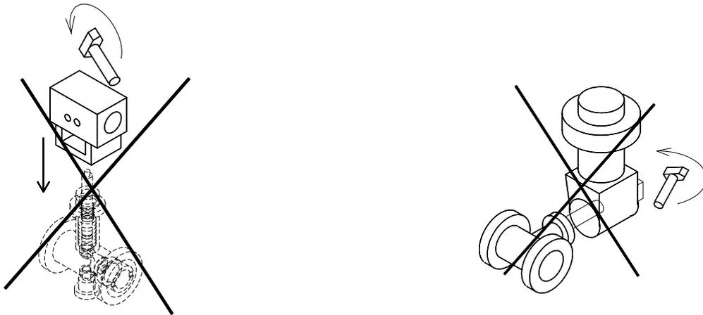
Um eine Dichtheit nach Außen zu gewährleisten, muss der Bereich zwischen Panzerbuchse und Gehäuse beidseitig mit der Dichtungsfläche abgedeckt werden.
