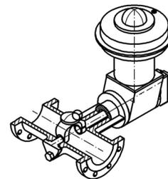
Der Stellantrieb darf nur in senkrechter Stellung eingebaut werden. Bei Einbau in eine andere Stellung kann es zum Defekt und somit zur Fehlfunktion des Stellantriebes kommen.
