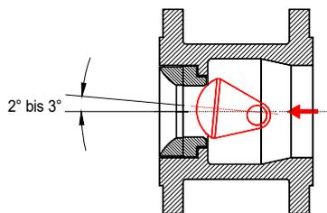
Die Armatur sollte deshalb vor Beginn der Inbetriebnahme leicht geöffnet sein (Winkel ca. 2° bis 3°) und kann nach Inbetriebnahme (d.h. nach gleichmäßiger Wärmeverteilung durch das Medium) wieder geschlossen werden (siehe Abb.2).
