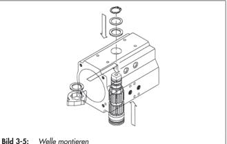
Nocken (1) in der gewünschten Position, bezogen auf die Stellung des Wellenkopfes und Wellenfußes, sowie die Drehrichtung des Antriebs montieren, vgl. Bild 3-6.
