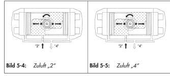
Zuluft auf Anschluss "2" bewegt die Kolben in Richtung der Endlagen,vgl. Bild 5-4. Abluft über Anschluss "4", eine Drehrichtung im Uhrzeigersinn ist vorausgesetzt. ⇒ Zuluft auf Anschluss "4" bewegt die Kolben in die Mitte, vgl. Bild 5-5. Abluft über Anschluss "2", eine Drehrichtung im Uhrzeigersinn ist vorausgesetzt.
