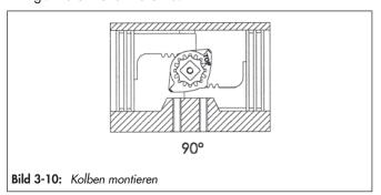
⇒ Überprüfen, dass die Kolben in Endstellung die Welle 4° über die Mittellinie (0°) drehen, vgl. Bild 3-11.
