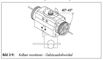
Beide Kolben (25) gleichzeitig in das Gehäuse (29) einpressen bis die Kolben greifen und das Gehäuse im Uhrzeigersinn oder im Gegenuhrzeigersinn bis zum Hubende drehen, vgl. Bild 3-9 und Bild 3-10.
