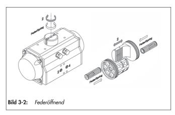
Soll die Welle des Antriebes beim Öffnen der Armatur im Uhrzeigersinn drehen, werden gegenüber der Standardausführung die Kolben entsprechend dem "Bild 3-2: Federöffnend" eingebaut.
