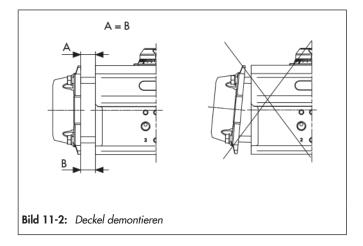
⇒ Kompression der Federn lösen. Dabei jede Deckelschraube (13) um jeweils eine Umdrehung gemäß der in Bild 11-1 gezeigten Reihenfolge um die in Tabelle 11-1 angegebene Anzahl von Umdrehungen teilweise herausdrehen.
