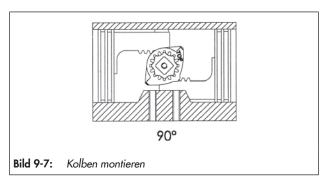
Überprüfen, dass die Kolben in Endstellung die Welle 4° über die Mittellinie (0°) drehen, vgl. Bild 9-8.
