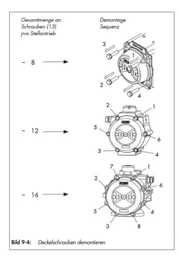
Kompression der Federn lösen. Dabei jede Deckelschraube (13) um jeweils eine Umdrehung gemäß der in Bild 9-4 gezeigten Reihenfolge um die in Tabelle 9-1 angegebene Anzahl von Umdrehungen teilweise herausdrehen.
