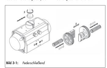
Die Standard Version der BR 31a Schwenkantriebe wird längs zur Durchflussrichtung der Armatur aufgebaut.
