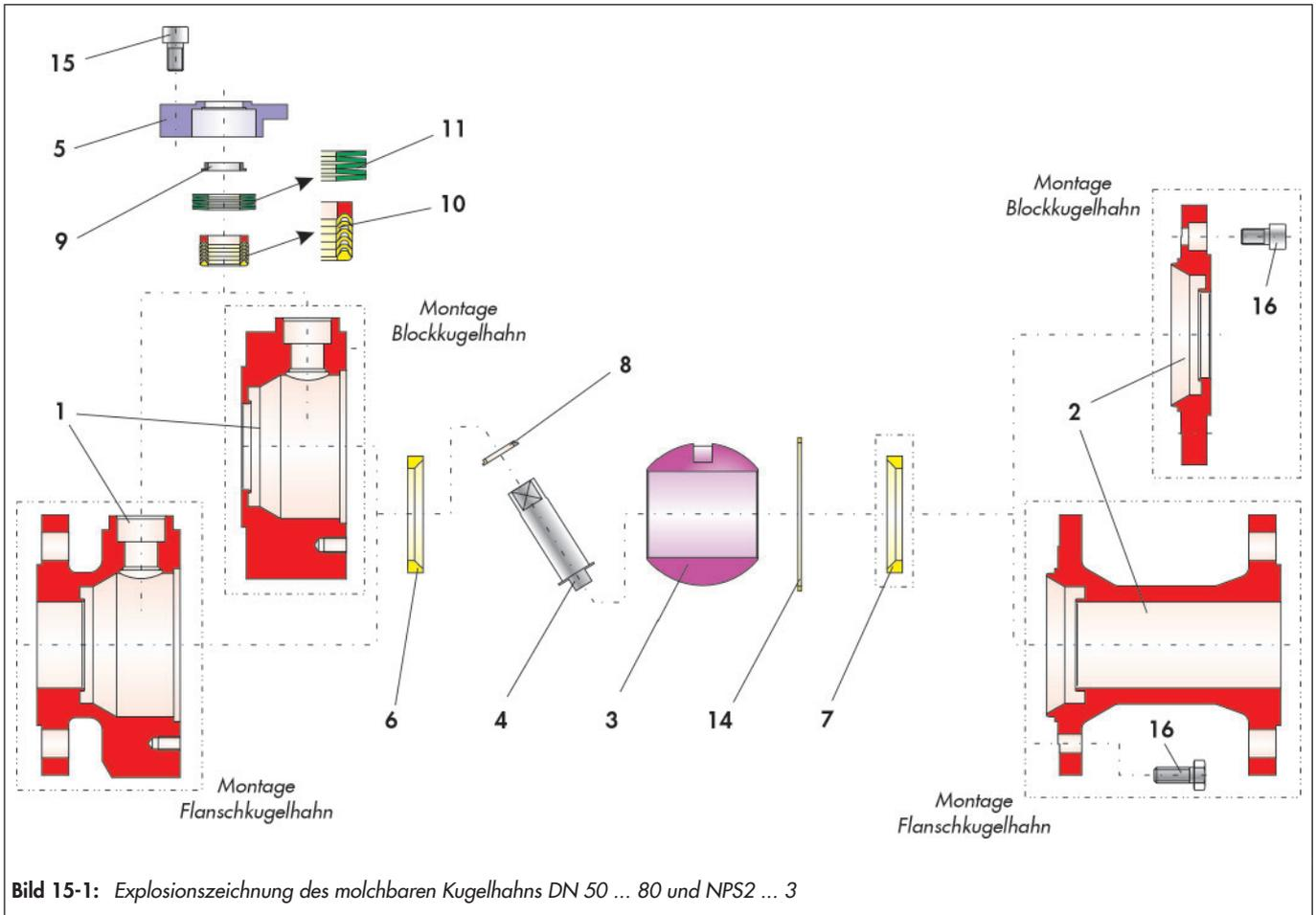
Bild 15-1: Explosionszeichnung des molchbaren Kugelhahns DN 50 ... 80 und NPS2 ... 3
