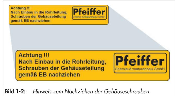
**Bild 1-2:** Hinweis zum Nachziehen der Gehäuseschrauben
