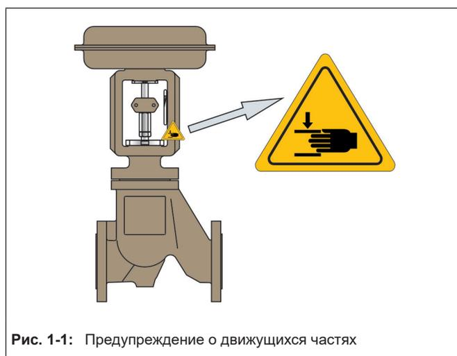
Рис. 1-1: Предупреждение о движущихся частях
